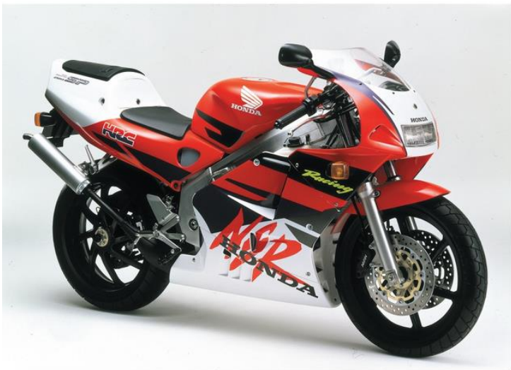
ホンダ NSR250R 2ストローク 2気筒 40馬力 157kg ストローク量 54.5mm
